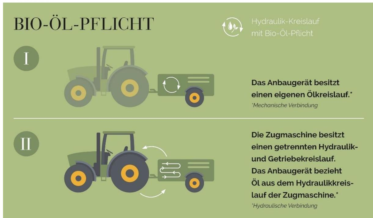
Abbildung 1: Übersicht zur Verwendung von Bio-Hydraulik-Öl in forstlichen Anbaugeräten
