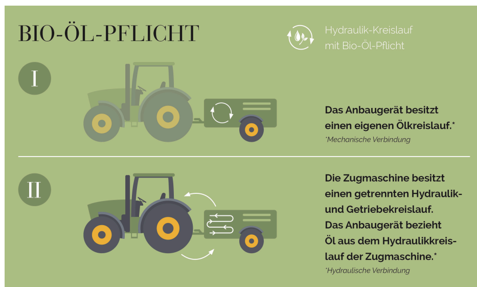
Abbildung 1: Übersicht zur Verwendung von Bio-Hydraulik-Öl in forstlichen Anbaugeräten
