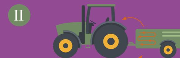
Die Zugmaschine besitzt einen getrennten Hydraulik- und Getriebekreislauf. Das Anbaugerät bezieht Öl aus dem Hydraulikkreislauf der Zugmaschine.\*
